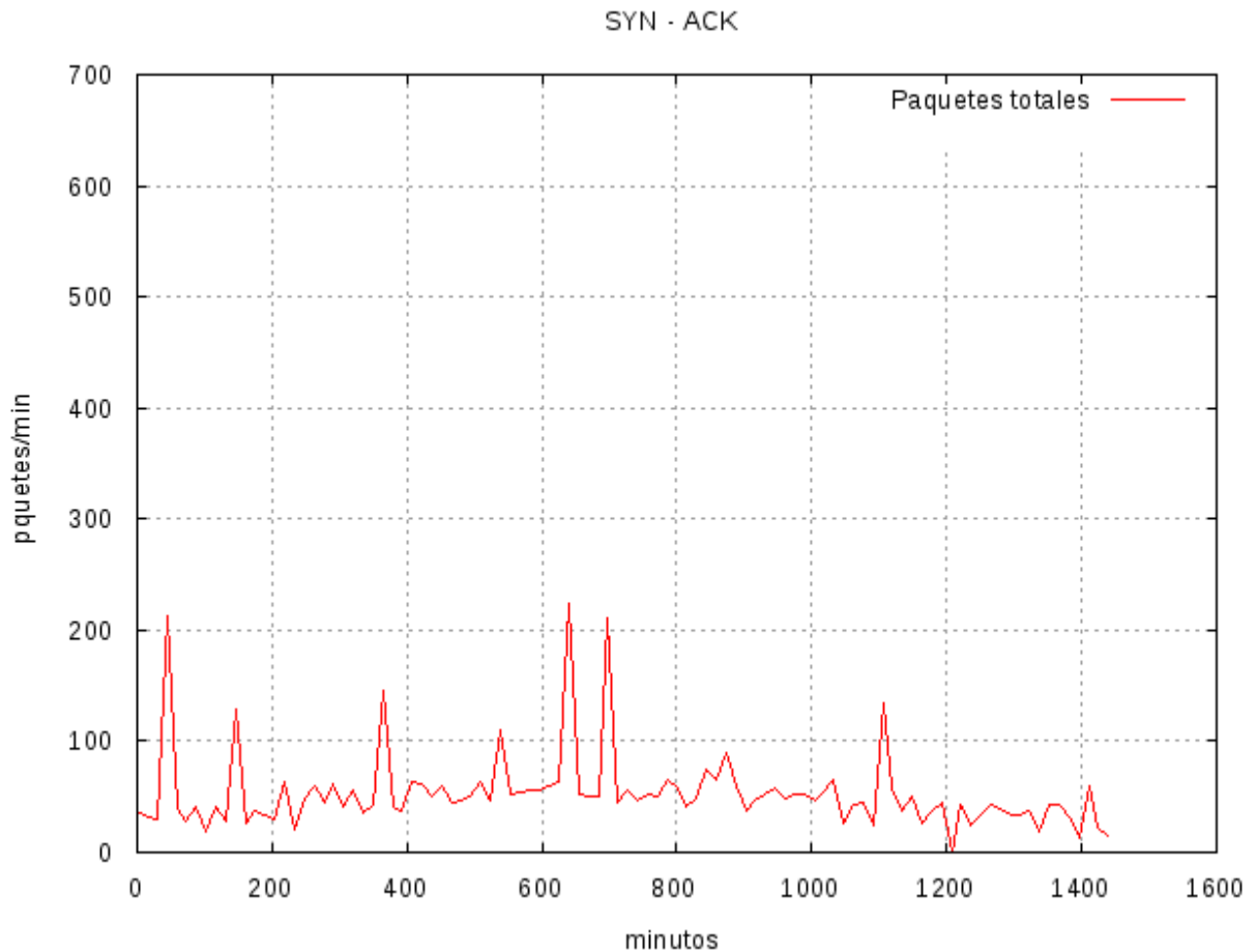
Figura 17: Paquetes totales durante un día (no se observan paquetes con flag TCP-SYN activada).
