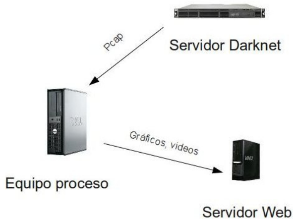
Figura 6: Esquema de proceso generación de gráficos y videos. La flecha indica una conexión segura entre las máquinas.
